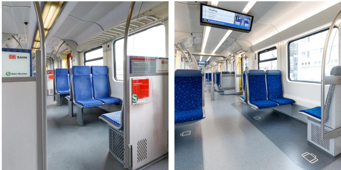
Abbildung 5: Umbau der Sitzgruppen in der Baureihe 423 im Rahmen des Redesigns bei der S-Bahn München (Quelle: S-Bahn München / wunderland media GmbH)
