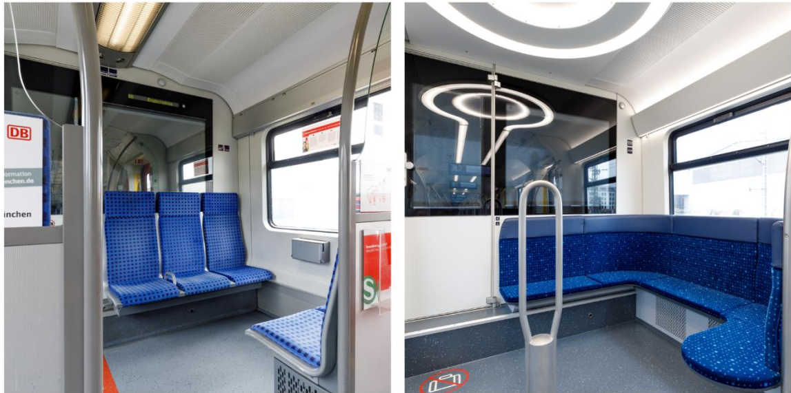
Abbildung 6: Umbau der 1. Klasse zu einer Sitzgruppe in der Baureihe 423 im Rahmen des Redesigns bei der S-Bahn München (Quelle: S-Bahn München / wunderland media GmbH)
